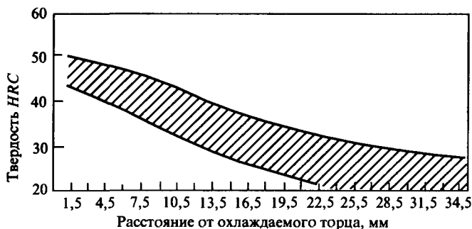
Рис. 18. Полоса прокаливаемости стали 30ХГТ
