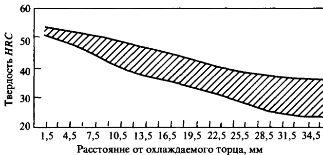
Рис. 21. Полоса прокаливаемости стали 30ХГСА
