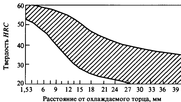
Рис. 15. Полоса прокаливаемости стали 45Г2
