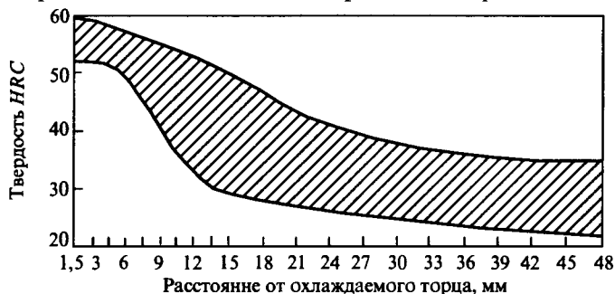
Рис. 14. Полоса прокаливаемости стали 40Г2
