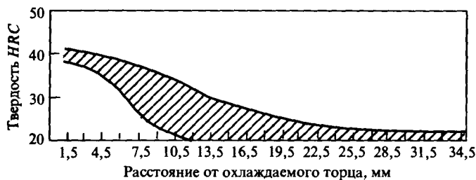
Рис. 26. Полоса прокаливаемости для стали 12ХН3А
