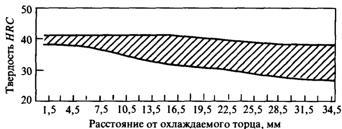
Рис. 27. Полоса прокаливаемости для стали 12Х2Н4А
