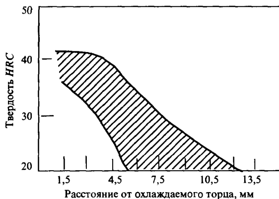
Рис. 7. Полоса прокаливаемости стали 15X
