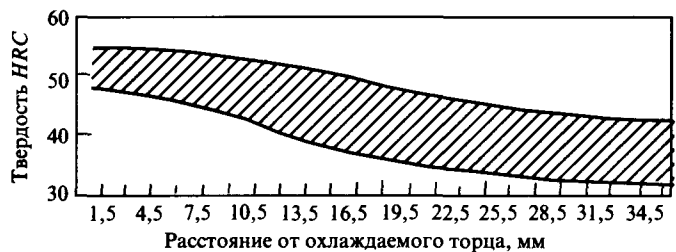
Рис. 20. Полоса прокаливаемости стали 38ХС
