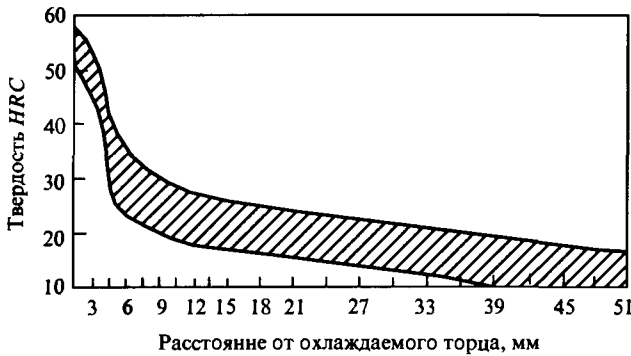
Рис. 2. Полоса прокаливаемости стали 40
