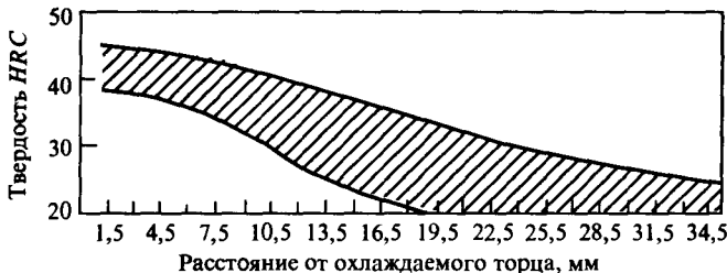
Рис. 17. Полоса прокаливаемости стали 20ХГР
