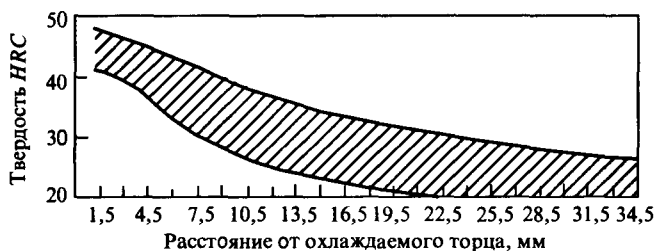
Рис. 16. Полоса прокаливаемости стали 18ХГТ
